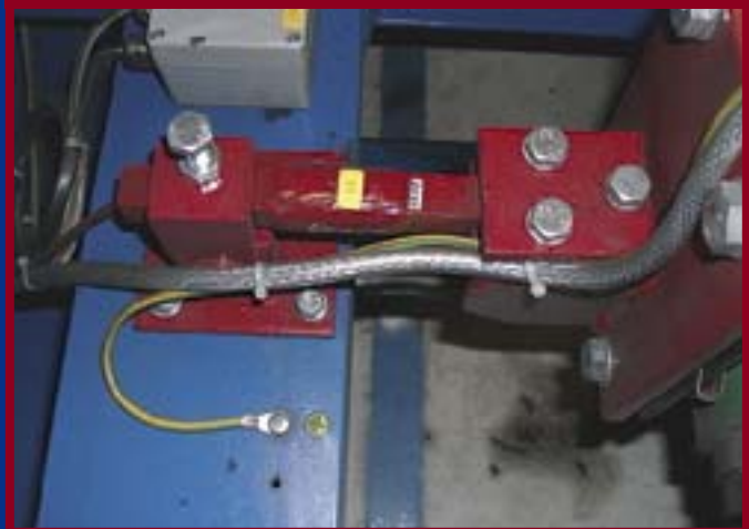
A pontos mérési eredményhez nélkülözhetetlen a nyúlásmérő bélyeg
