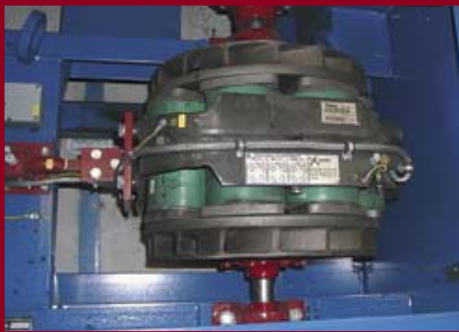
Tengelyenként egy-egy örvényáramú elektromos fék szimulálja a menetellenállást
