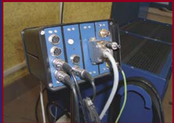
A számítógép ezen az interface-en keresztül kapja a mérési jeleit
