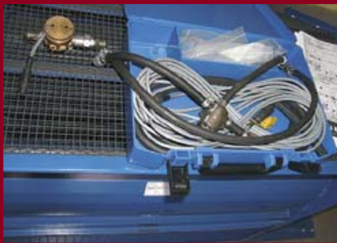
A fogyasztásméréshez egy átfolyásmérőt kell a jármű üzemanyagrendszerébe építeni
